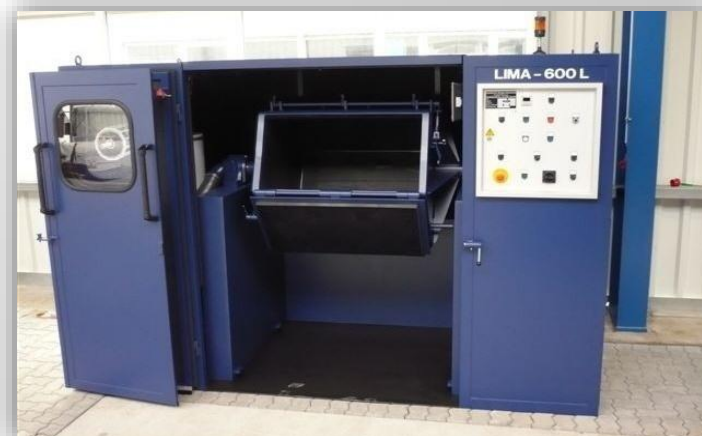
Bębnowa maszyna do gratowania
