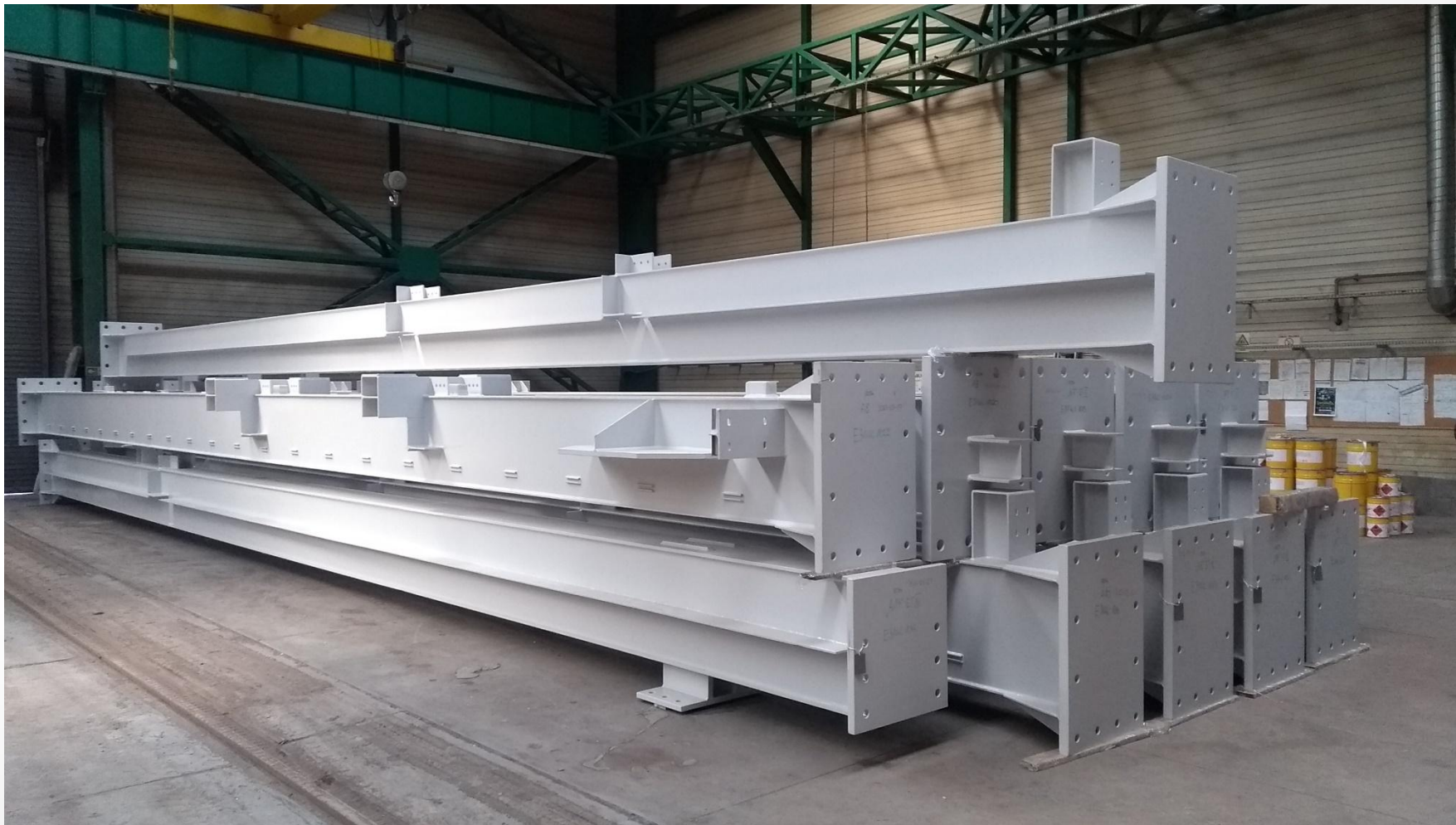
Spawane belki i słupy, NORDEC (Frey Giga Arctic)
